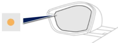
При этом в наружном зеркале заднего вида с соответствующей стороны загорается сигнальная лампа:
