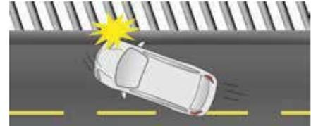
Если автомобиль врезается в ограждение или другое транспортное средство под углом, датчики системы не распознают замедление, и подушка безопасности не срабатывает.
