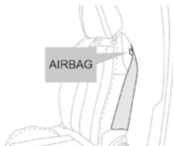
В случае сильного бокового удара боковые подушки безопасности защищают водителя и переднего пассажира, сводя к минимуму травмы грудной клетки и боковой части туловища. Боковые подушки безопасности встроены в каркас спинки сиденья со стороны двери.
