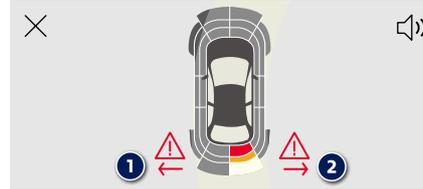
При приближении к препятствию в случае его обнаружения датчиками парковки на сенсорном экране в различных режимах мигает значок 1 или 2, а при движении задним ходом включается звуковой сигнал.
