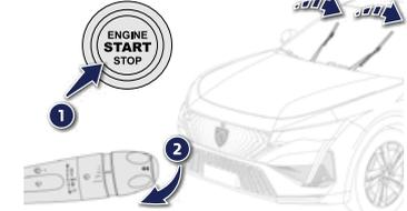
При включении стеклоочистителя, сразу после выключения зажигания, щетки переместятся в вертикальное положение. Это позволяет очистить или заменить щетки, а также использовать это положение в зимнее время, чтобы поднять щетки во избежание примерзания. Для возврата щеток в нормальное положение включите зажигание и затем нажмите выключатель стеклоочистителя.
