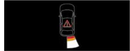
Система дополняет собой звуковой сигнал, отображая на экране полосы, которые указывают на расстояние между препятствием и автомобилем (белые: удаленные препятствия; оранжевые: близкие препятствия; красные: очень близкие препятствия). При максимальном приближении к нему на дисплее появится символ «Опасно».
