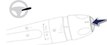
При последовательных нажатиях на торцевую кнопку выключателя стеклоочистителя одна за другой открываются следующие вкладки:
