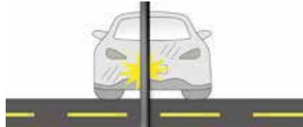
При фронтальном столкновении со столбом или деревом энергия удара в значительной степени поглощается деформацией кузова автомобиля, а замедление не достигает уровня срабатывания подушки безопасности, поэтому она не срабатывает.
