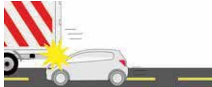
Когда автомобиль врезается в нижнюю часть грузового автомобиля или другого крупногабаритного транспортного средства, датчик системы не распознает замедление, и подушка безопасности не срабатывает.
