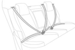
Задние сиденья оснащены 3-точечными ремнями с инерционными катушками. Ремни безопасности для боковых мест оборудованы преднатяжителями и ограничителями усилия натяжения.
