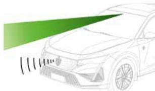
Автомобиль оснащен радаром в переднем бампере и камерой под ветровым стеклом.
