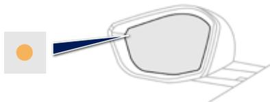
Когда система обнаруживает приближение препятствия, загорается предупредительная лампа в соответствующем боковом зеркале, а при движении задним ходом лампа мигает и раздается звуковой сигнал. Система включена по умолчанию.
