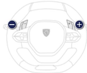
При вождении в режимах **M** или **D** водитель может переключать передачи при помощи переключателей за рулевым колесом.
