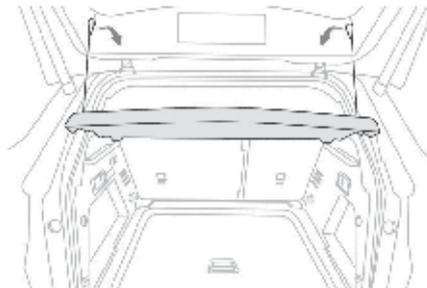
Для снятия полки багажного отделения выполните следующее.
