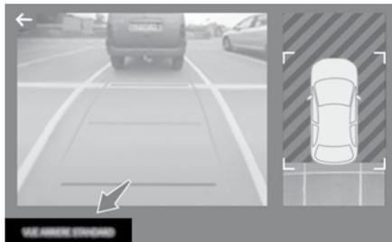
Чтобы включить камеру, расположенную на крышке багажного отделения, включите заднюю передачу и не превышайте скорость 10 км/ч.
