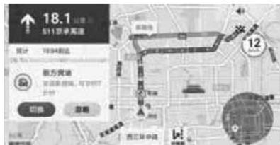
В процессе навигации система автоматически предложит [Избегать пробки] в соответствии с дорожными условиями, нажатие кнопки [Избегать] позволит перепланировать маршрут.
