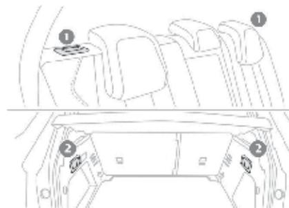
С каждой стороны спинки имеется два привода механизма блокировки:
