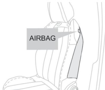
Данная система предназначена для защиты водителя и пассажира переднего сиденья в случае серьезного бокового удара от травм грудной клетки, области между тазобедренным суставом и плечом.
